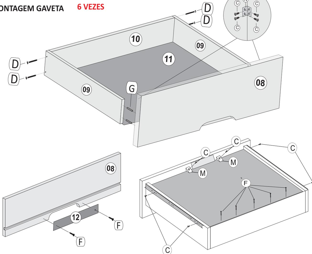
\*\*\* Se a corredeia estiver pesada de forma anormal, verifique se está encaixada corretamente nas canaletas, retire-a e torne a encaixar verificando novamente.
